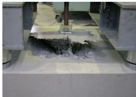
図-9 引抜きせん断破壊状況 (FRC)
