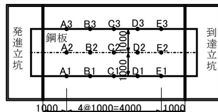
図-19 鉛直変位測定位置平面
