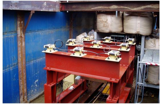
写真-4 高さ調整ローラー試験状況
