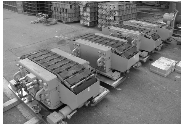
写真-1 シンクロジャッキ
