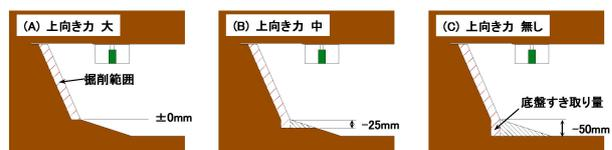
図-7 掘削装置概要図（テーパ形状刃口による底面すきとり量調整方式）
