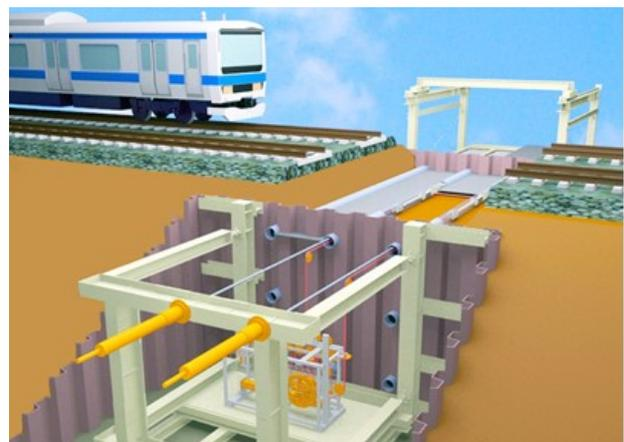
図-3 COMPASS工法概要図
