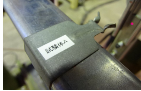
写真-5 試験体A破断状況
