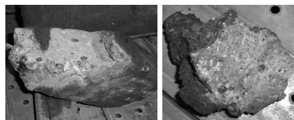
図-11 地盤切削ワイヤーによる切削状況
