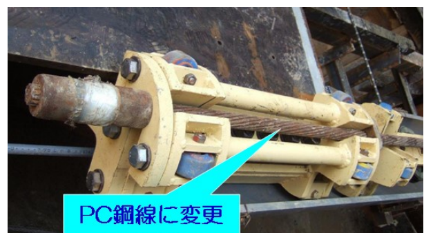
図-5 改良後ガイドプーリー構造
