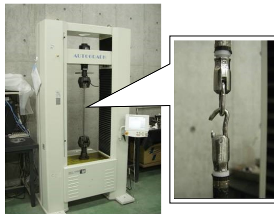
写真-3 切削ワイヤー引張試験状況
