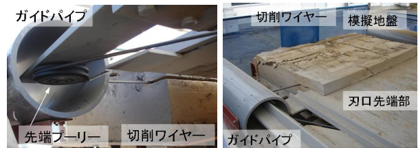
写真-12 切削試験状況
