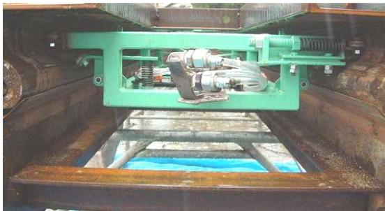
写真-7 鉛直対応吹付け装置
