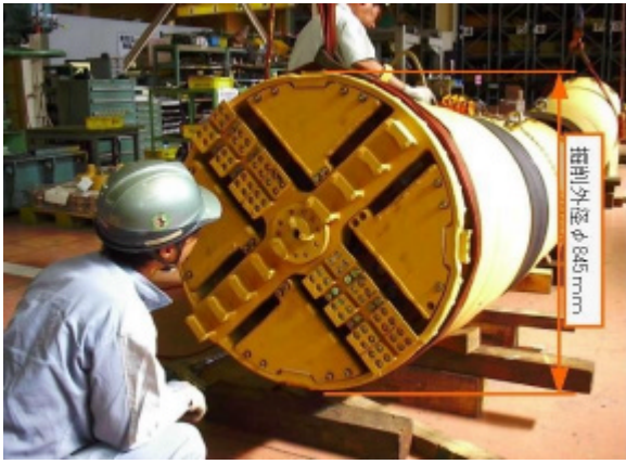
(写真 2 太径曲線パイプルーフ推進機)(写真 3 下向き実大規模実証実験状況)
