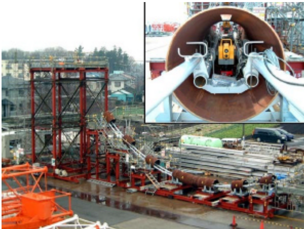
(写真 4 計測機器実大規模実証実験状況)(写真 5 発進・到達坑口止水実験状況)
