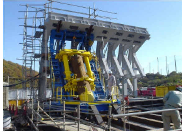
(写真 2 太径曲線パイプルーフ推進機)(写真 3 下向き実大規模実証実験状況)
