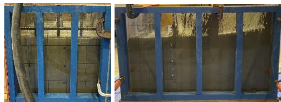
図-9 ケース 1 の加振後の充填状況 (上：解析結果，下：実験結果)
