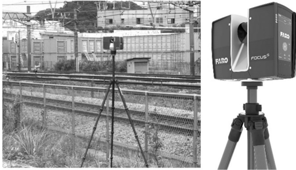
写真-1 スキャン状況と FARO Focus3D
