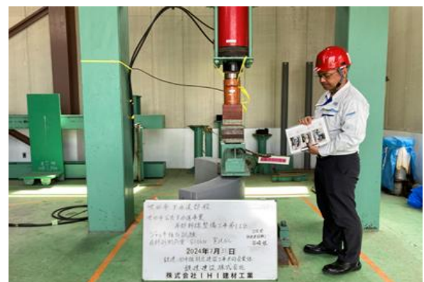
写真-8 ジャッキ推力試験
