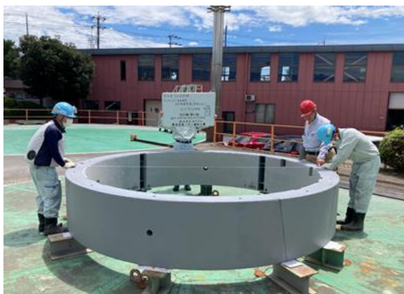
写真-9 水平仮組試験
