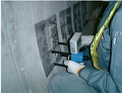
写真-1 付着強度の事前確認状況
