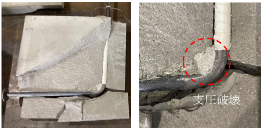
(a) 試験体全容 (b) 曲げ加工部近傍 写真-2 試験体 No.2 の破壊状況
