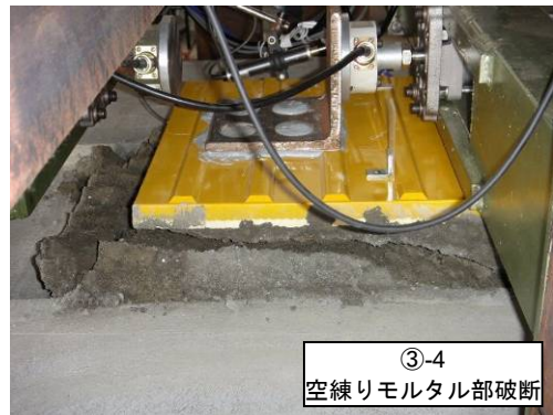
写真-3 荷重試験後の状況(空練りモルタルの厚さによる影響, 試験体③-4)
