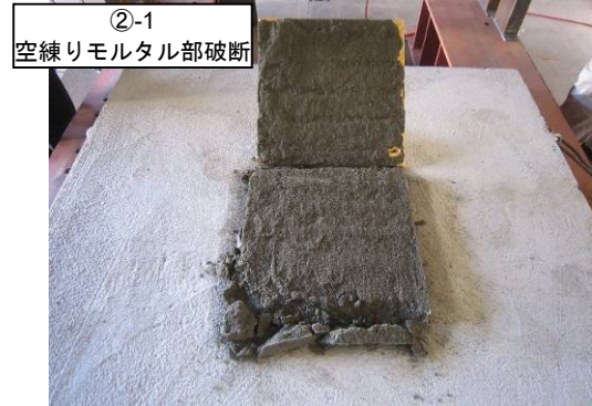
写真-2 荷重試験後の誘導ブロック裏面の状況(養生時間による影響, 試験体②-1)
