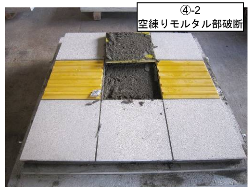
写真-4 荷重試験後の誘導ブロック裏面の状況 (9枚張り, 試験体④-2)
