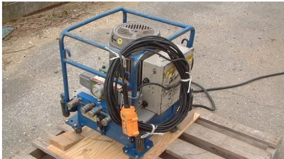
写真-5 割岩機の油圧ユニット
