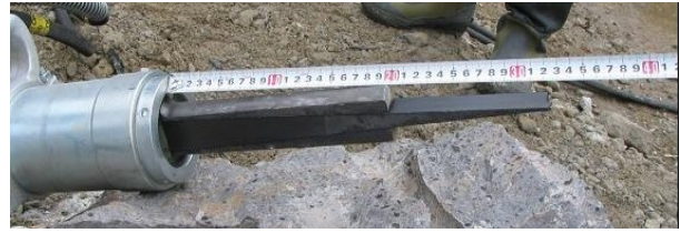
写真-2 割岩機のウェッジ部
