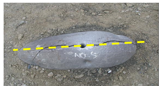
写真-11 割岩状態(強度 142MPa)
