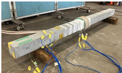
写真-4 誘導加熱状況
