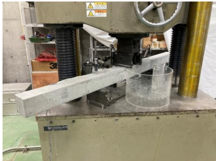
写真-5 荷重試験状況
