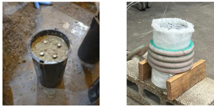
写真-2 試験体作成状況(左)と加熱状況(右)
