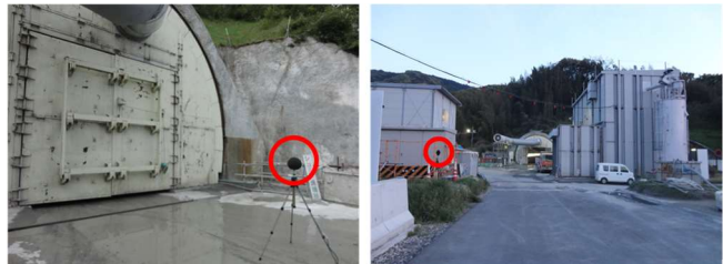
坑口防音扉外側5m点 坑口防音扉外側60m点 写真-2 低周波音の測定点
