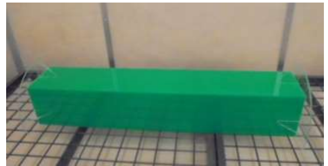
写真-2 共鳴器型消音器(アクリル製5mm厚)
