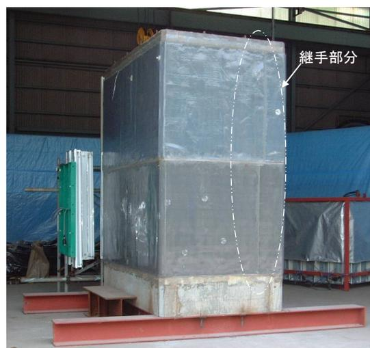
写真-4 1層貼付け後の継手部状況
