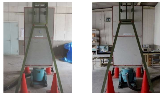
写真－８ 列車振動促進暴露試験の状況 a) 繊維補強セメント板 b) フレキシブルボード
