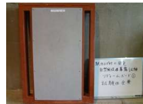
写真-4 自然風促進暴露試験用試験体
