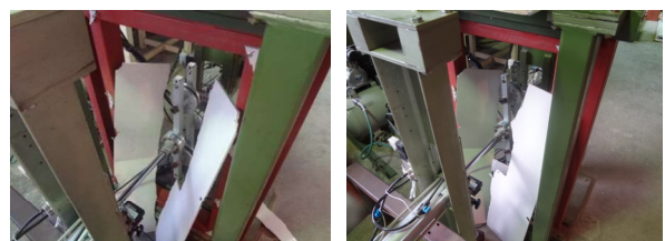
a) フレキシブルボード① b) フレキシブルボード③ 写真-15 フレキシブルボードの破壊状況
