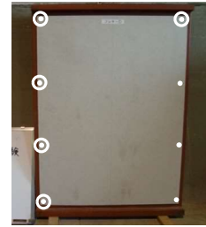
※○印:ねじ周りのひび割れ発生箇所
