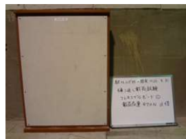
写真－６ 繰り返し载荷試験用試験体
