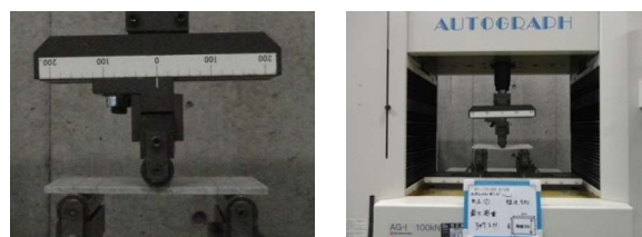
写真-10 曲げ試験の状況
