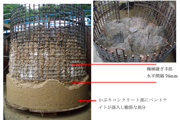
写真-2 硬化後の外観状況 (実験ケース①)
