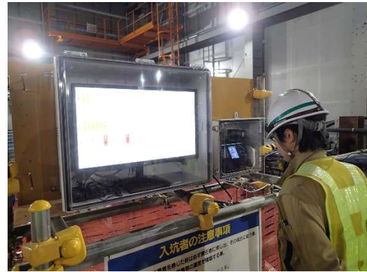
写真-7 顔認証機による入出坑検知状況 (シールドトンネル)
