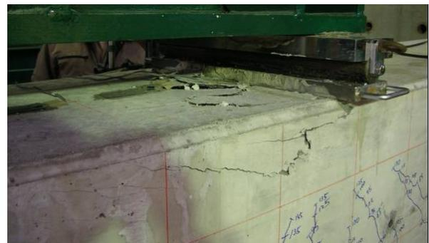
写真-4 改良タイプ最大荷重時の状況
