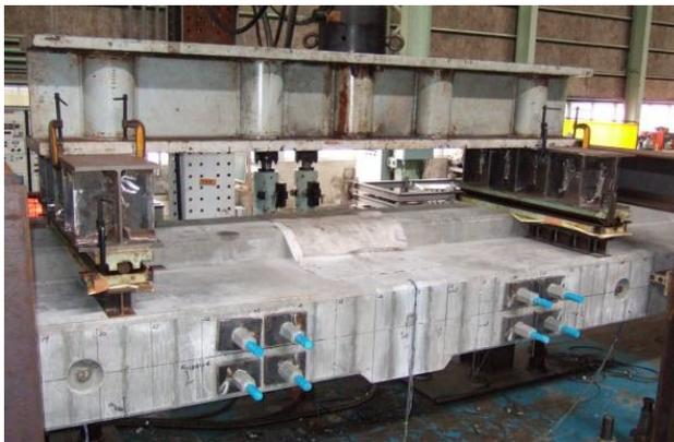
写真-5 疲労荷重試験状況
