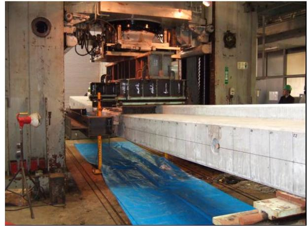
写真-6 低サイクル破壊試験状況
