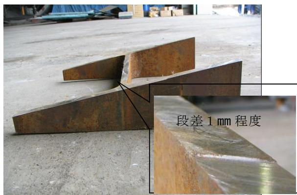
写真-12 フランジ方向 20%勾配切断面
