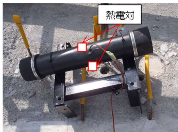
写真-1 斜材ダミーケーブル
