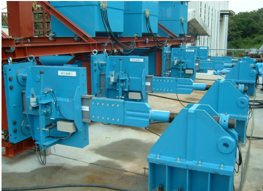
写真-3 ジャッキ部分
