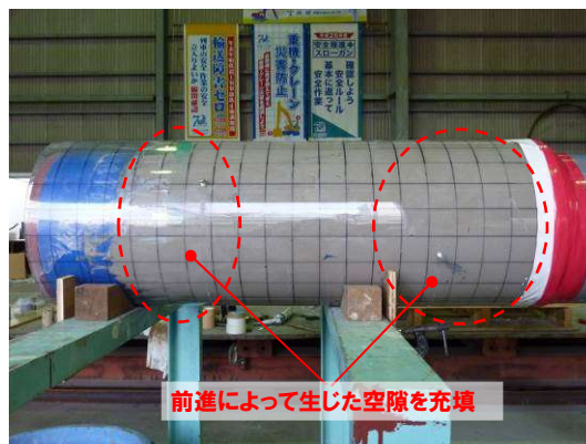
写真-7 4回目注入完了
