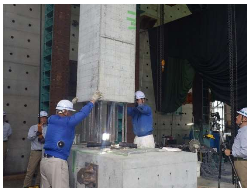
写真-2 柱部材建て込み
