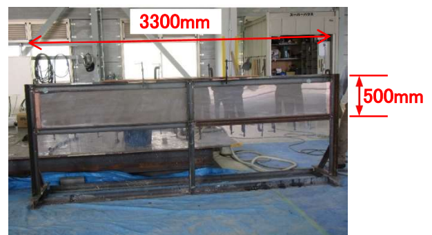
写真-7 充填性確認試験
