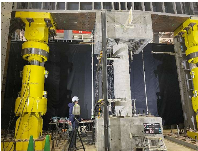
▲高強度鉄筋を用いた杭体の構造性能確認実験状況
