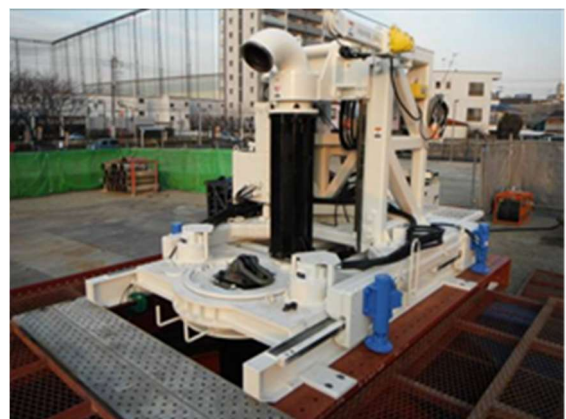
写真-13 超低空頭場所打ち杭掘削機
