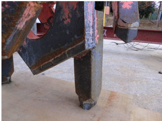
写真-8 パイロット部シェルビット
