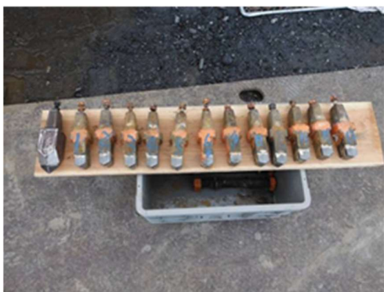
写真-16 回収した先行ビット
