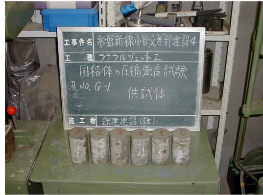
写真-5 強度確認試験
