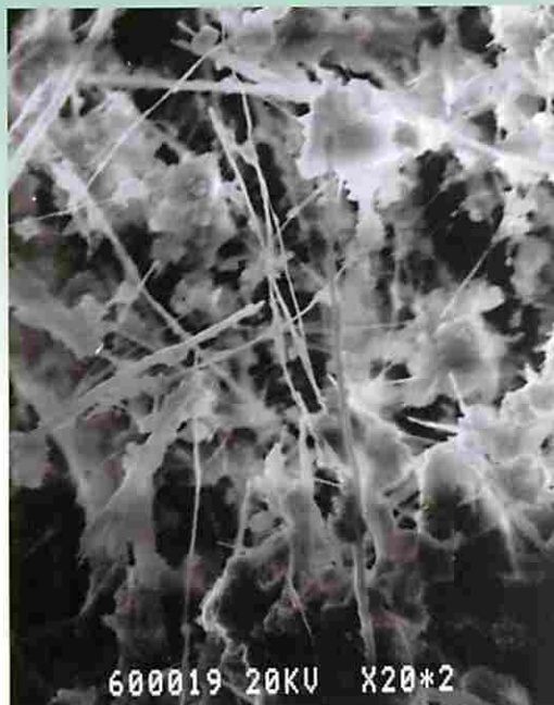
未処理アスベスト
