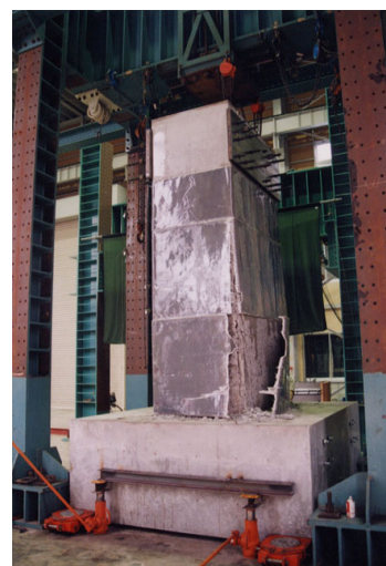
写真-4 終局時のシート破断状況
