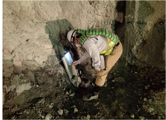
写真-3 クリノメーターによる測定状況
