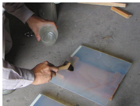
写真－４ トップコート塗布状況
