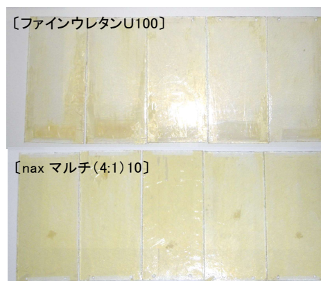
写真－５ 促進耐候性試験後の表面状況
