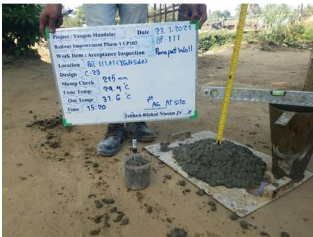
写真-2 スランプ試験結果の例 (ミャンマーの例)
