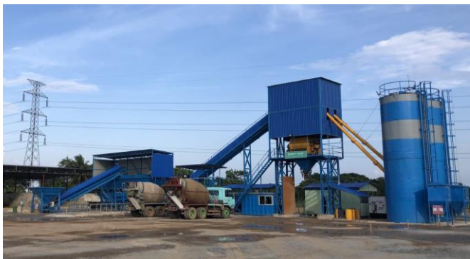
写真-1 現場生コン工場の例（ミャンマーの例）
