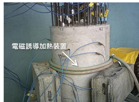
写真-1 加熱状況
