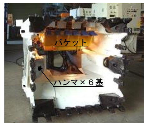
写真-1 礫対応掘削装置
