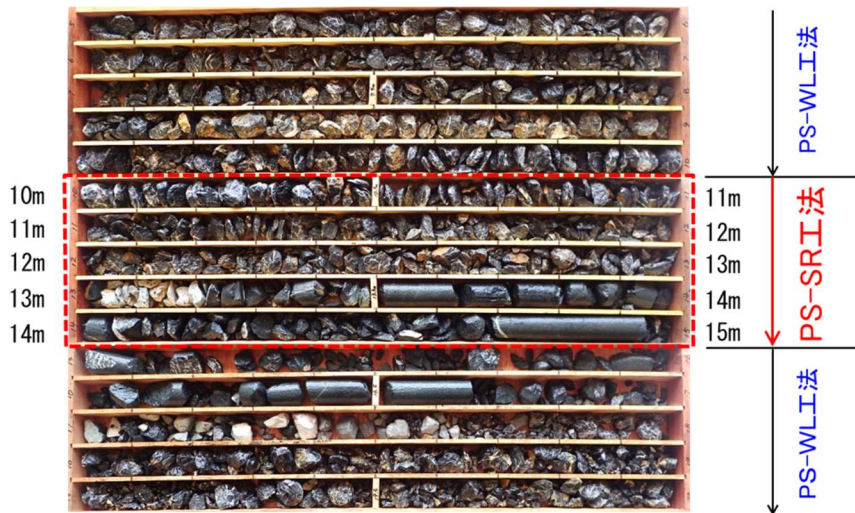
写真-7 現地試験における採取コア
