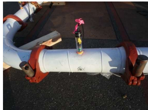
写真-1 フラッシュダイヤフラム型圧力計
