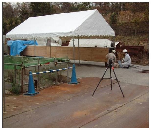
写真-12 騒音測定離隔距離6m
