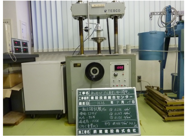
写真－7 一軸圧縮試験状況
