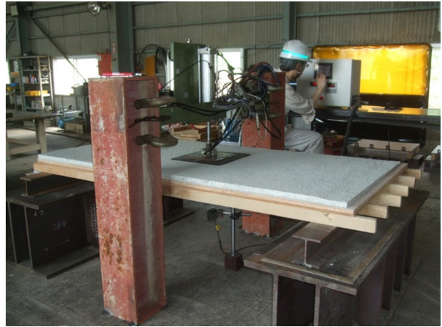
写真-12 繰り返し載荷試験状況
