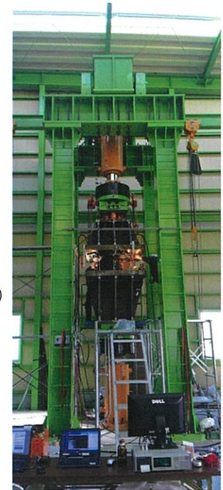
写真.2 鉛直荷重保持試験状況
