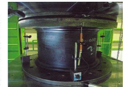
写真.3 試験状況(積層ゴム)
