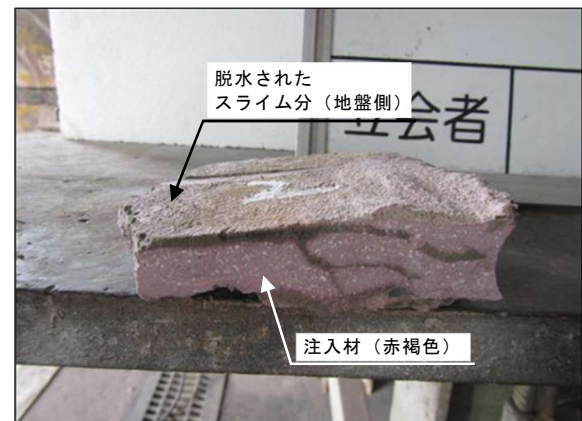
b) 注入材の割裂注入状況
