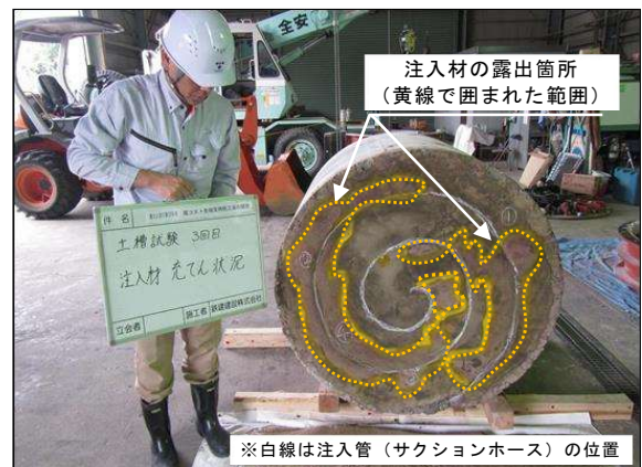
写真-3 注入材充填状況 1 (CASE3)
