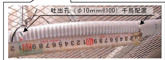
写真-1 注入管 (らせん形状)
