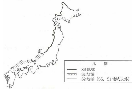
図-8 塩化物イオンに関する検討における海岸の地域区分 2)
