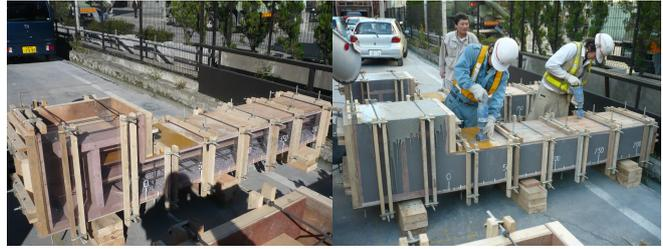
写真-3 流動性確認試験
