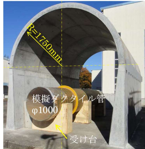
写真-3 模擬トンネルの全景
